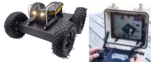
Рисунок 1. Загальний вигляд робота SuperDroid Robots та пульт дистанційного керування
