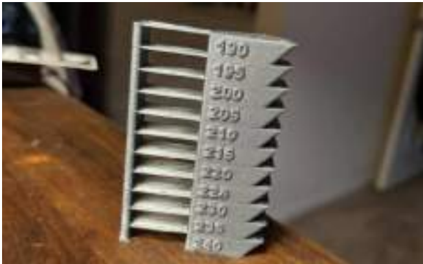
Рис.6. Порівняння екструзії при різних температурах сопла
