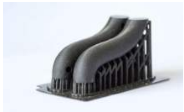
Рис.9. Приклад налаштованих параметрів підтримок
