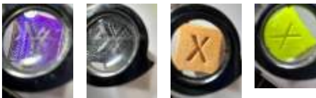
а) – зразок PLA пластику; б) – зразок PETG пластику; в) – зразок ABS пластику; г) – зразок Nylon пластику Рис.7. Результати тестових зразків на абсорбцію та гідратацію води
