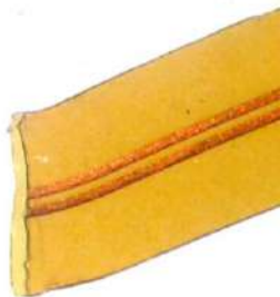
Рис.4. Розрив шлейфа досліджуваного зразка після динамічних вигинів
