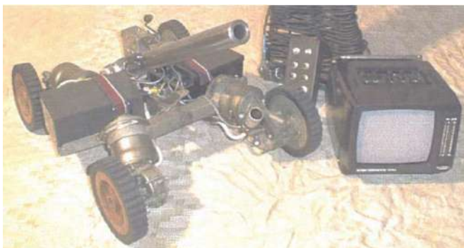
Рис. 1. Дистанційно-керований апарат для розвідки та знешкодження вибухонебезпечних предметів
